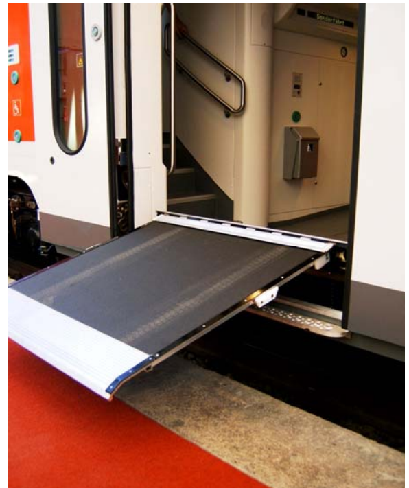
Doppelstockwagen der DB Regio an einem Bahnsteig 38 cm über SOK – automatische Überfahrbrücke wird ausgefahren
