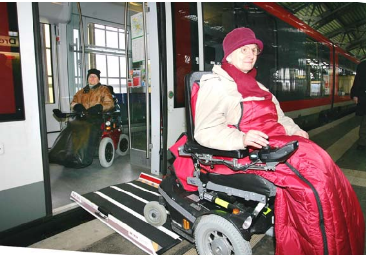
Anlegbare Überfahrbrücke der DB Regio am einem Dieseltriebwagen VT 642 an Bahnsteig 38 cm über SOK
