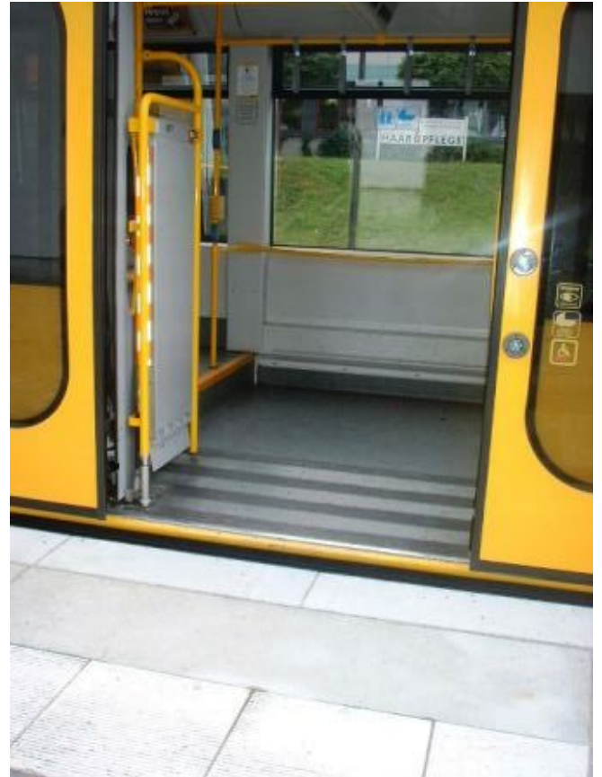
Niederflurstadtbahn Dresden an barrierefreier Haltestelle
