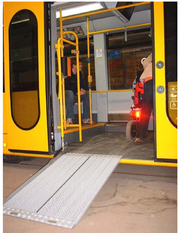
Niederflurstadtbahn Dresden mit Rampe an nicht barrierefreier Haltestelle
